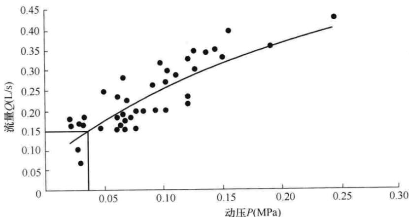
图 2 螺旋升降式水嘴半开  $Q$ - $P$  曲线
