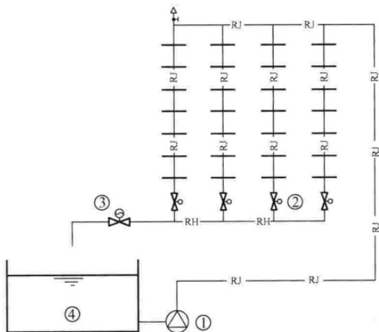
图 4 限流调节阀在热水系统中的应用
