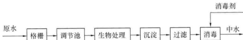
注：处理流程应根据原水水质、水量和中水的水质、水量及使用要求等因素，经技术经济比较后确定。
