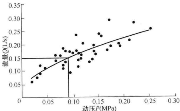
图 1 陶瓷阀芯水嘴半开  $Q$ - $P$  曲线
